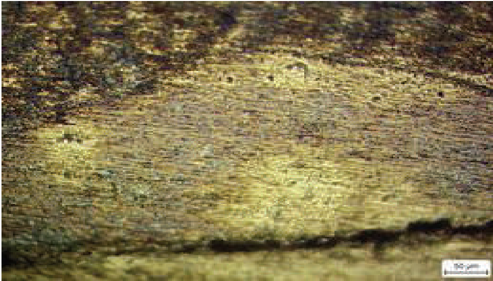
სურათი 3. დეფორმირებული მარმირებელი ფოლადის მავთული ბიმეტალში
