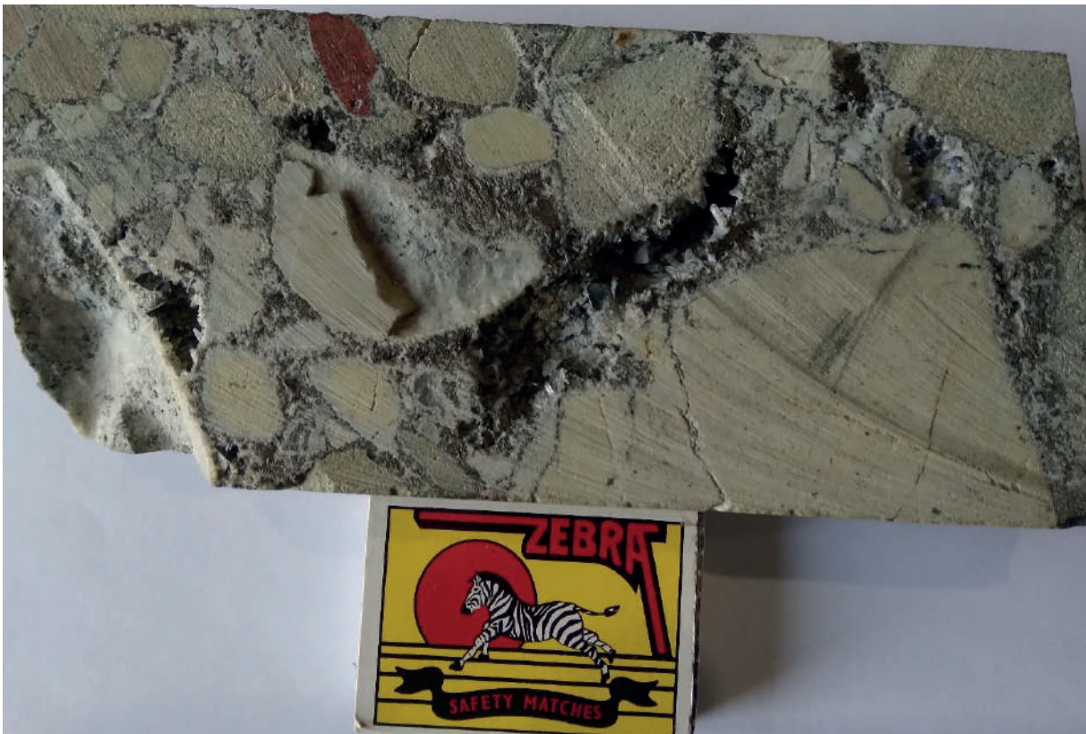
სურ. 5. კვარც-პირიტ-ქალკობირიტის ჟეოდეები ერუბტიულ ბრეჩიაში. გახერხილი ნიმუში ჭაბურღილი KED8 კერნიდან, ინტერვალი 71.2 მ
