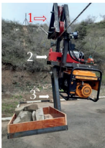
სურათი 4. სამთო ინსტიტუტში დამუშავებული თვითმავალი სატვირთო საბაგრო გზა
