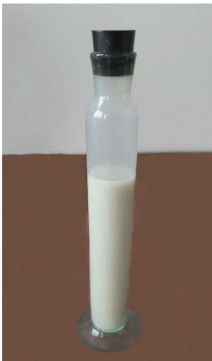
სურ. 1. ცილინდრი ციხისუბნის ნიმუშის ბენტონიტური რიცხვის განსასაზღვრავად
