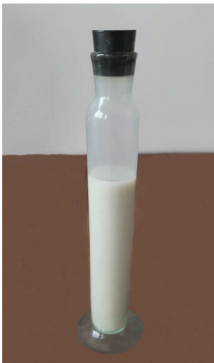
სურ. 1. ცილინდრი ციხისუბნის ნიმუშის ბენტონიტური რიცხვის განსასაზღვრავად
