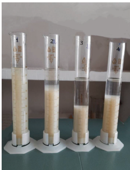
სურ. 2. ციხისუბნის ბენტონიტის გაჯირჯვებადობა ქიმიური რეაგენტების კომბინაციების მოქმედების შედეგად: 1 – საწყისი ნიმუში; 2 – დამუშავებული \text{Na}_2\text{CO}_3 + \text{CaO} ; 3 – დამუშავებული \text{Na}_2\text{CO}_3 + \text{MgO} ; 4 – დამუშავებული \text{Na}_2\text{CO}_3
