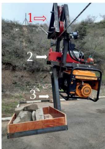
სურათი 4. სამთო ინსტიტუტში დამუშავებული თვითმავალი სატვირთო საბაგირო გზა
