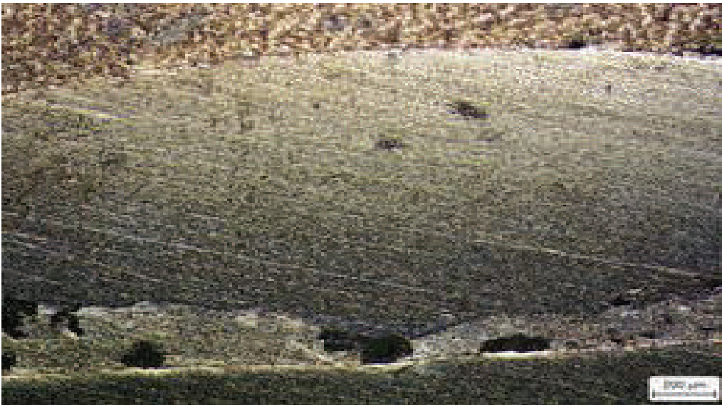
სურათი 6. გადნობის შედეგად მიღებული ერთიანი ინტერმეტალიდის ფენა
