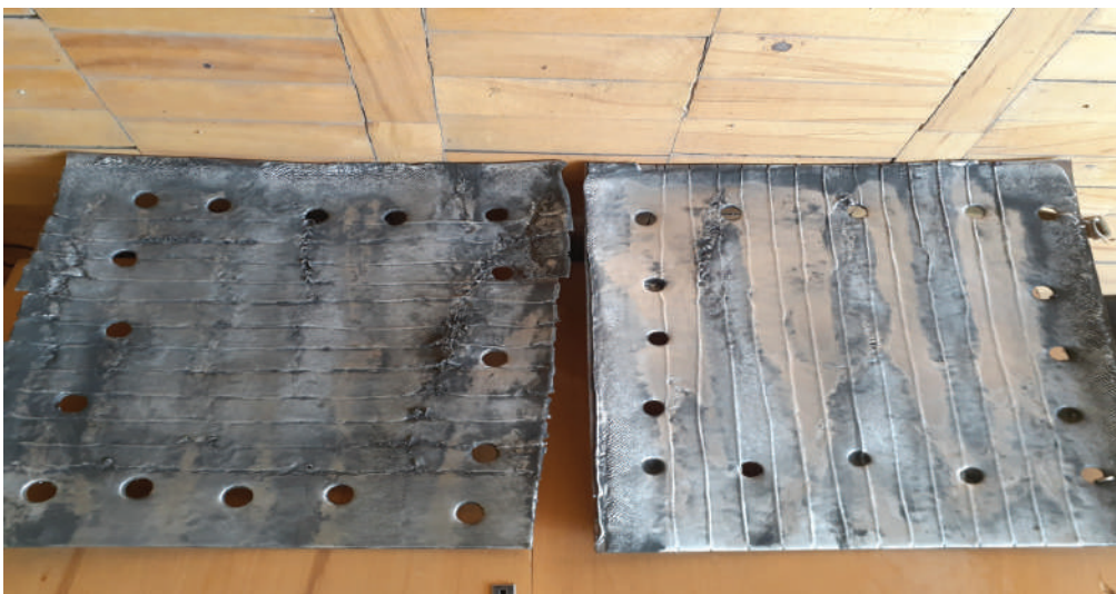
სურათი 2. აფეთქების მეთოდით შედუღებული და არმირებული კომპოზიციური მასალა
