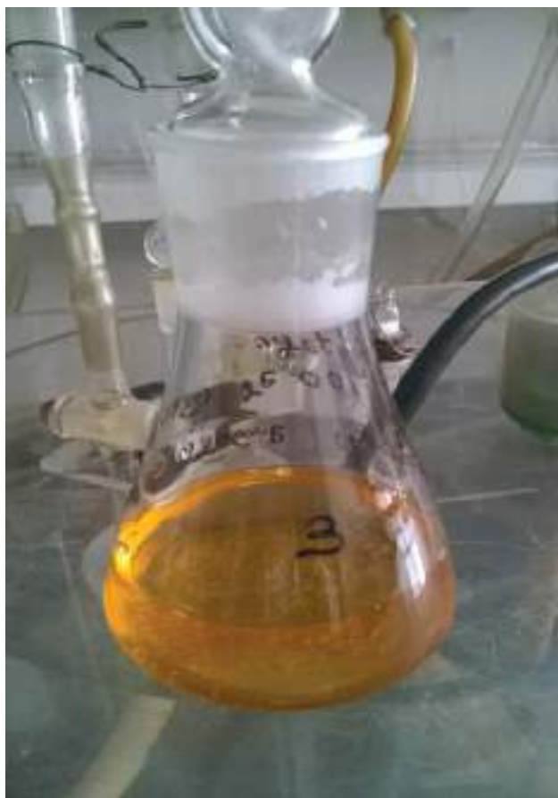
Рис.1. Отфильтрованное вино с кристалликами винного камня, полученное в опыте № 3
