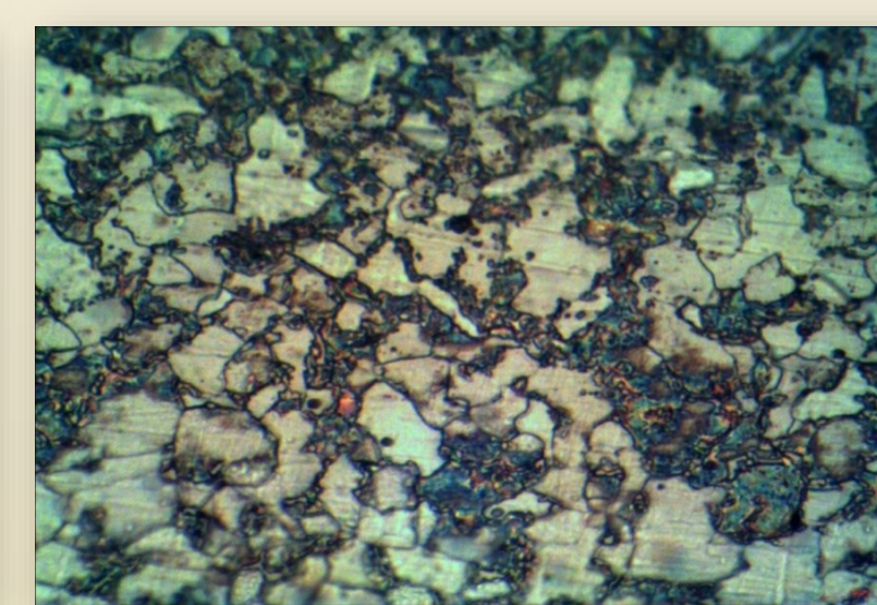
სურათი 3. აფეთქებამდე ლეგირებული ფოლადის სტრუქტურა.
