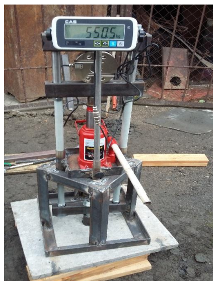
სურ. 3. ხელსაწყოს პროექტი; სურ. 4. ხელსაწყო ანკერის გამოცდის დროს
